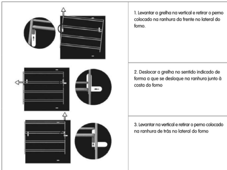
As Corredíças em aço inox que suportam as assadeiras esmaltadas podem ser retiradas e colocadas nos 3 níveis das grelhas laterais.
