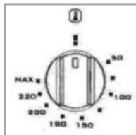
El mando del termostato permite seleccionar las temperaturas deseadas para su cocinado
