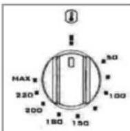
O manipulo do termóstato permite-lhe seleccionar as temperaturas mais ao seu cozinhado
