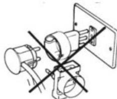
Antes de proceder à ligação do aparelho, verificar se a instalação eléctrica e o dispositivo de protecção estão de acordo com as características técnicas do aparelho.
