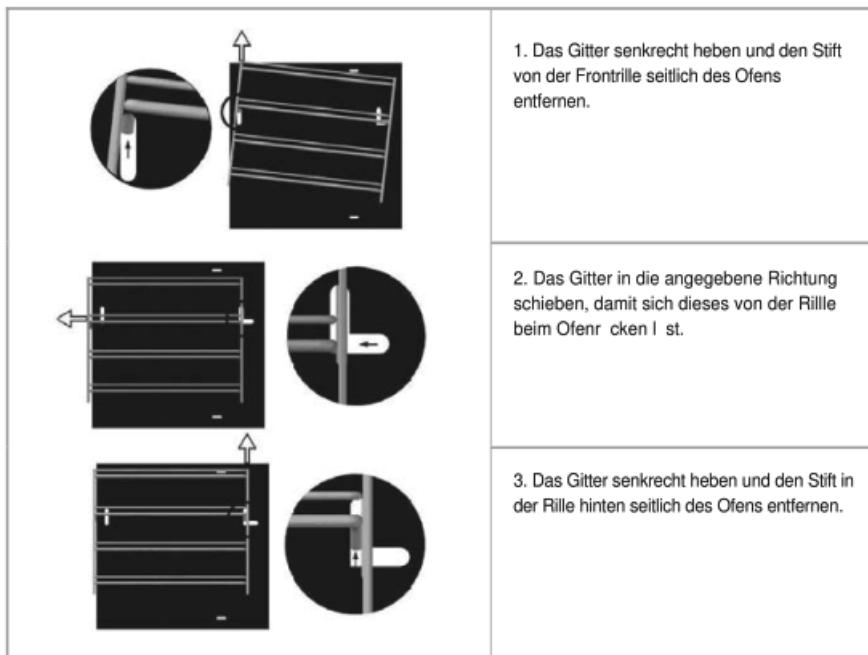
Die Edelstahlbahnen, die die Emaillebleche stützen, können entfernt und auf Stufe 3 der seitlichen Schienen eingeführt werden.
